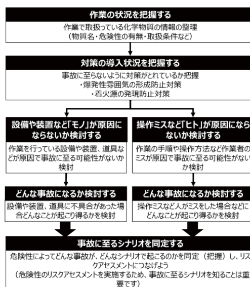
図 5 簡易シナリオ同定法実施支援ツールによる解析の流れ
