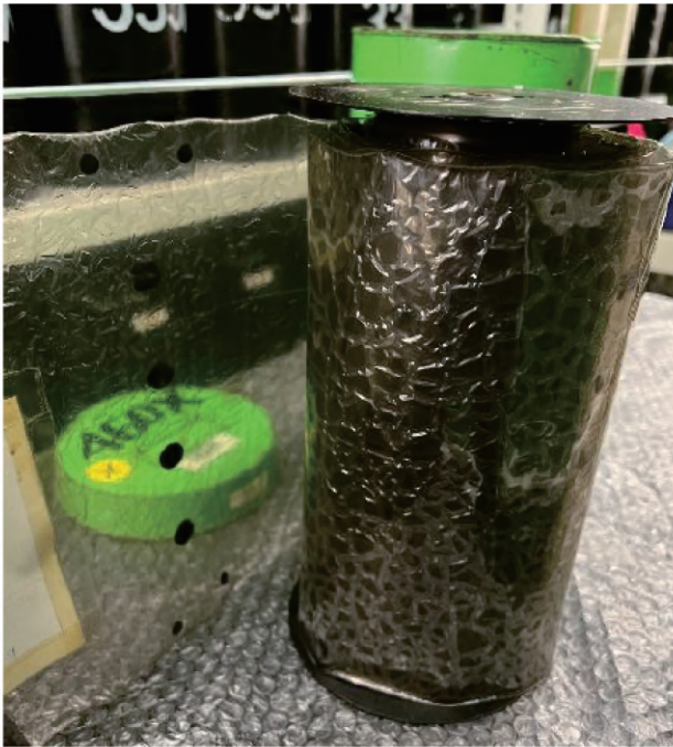
写真-1 フィルムの変形と剥離（直径約14cm、高さ約27cmの空中写真フィルム）
