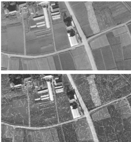
図-7 結晶化によるひび割れのような模様が生じた例（上：平成 21 年度，下：令和 3 年度数値化）。
