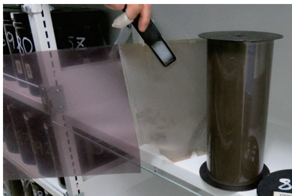
写真-5 PETフィルム（外側）とTACフィルム（内側）が接続された空中写真フィルム例
