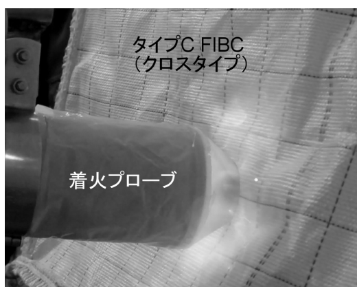
図8 着火プローブによるエチレン相当ガスの着火実験
