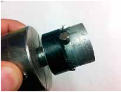
図1：ドライブシャフトピン孔の面圧破損
