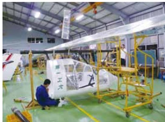
図 4.9 フェアリング完成図(右翼から)
