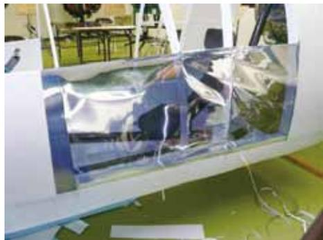
図 4.7 射光フィルム製外皮
