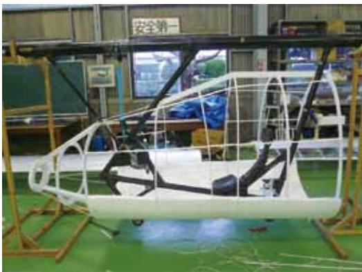
図 4.4 フェアリングの骨格完成後
