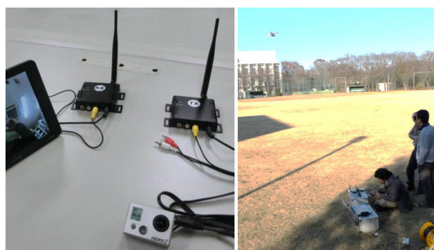
図 20 FPV 用に試用した WTW-TR23 ビデオ画像伝送装置とそれをを用いたデモフライト
