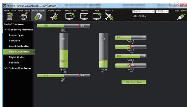
図 36 MissionPlanner の Radio Calibration 画面 Fig. 36 Radio Calibration screen of Mission Planner.
