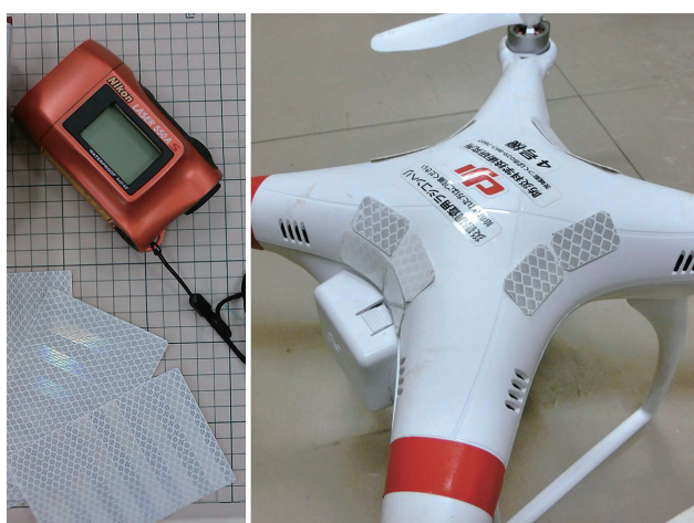
図 21 ゴルフ用レーザー距離計(左)および DJI Phantom の機体に貼った反射テープ(右)
