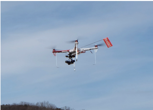
図 25 遠方から機体の向きを認識するためのテールフラッグ
