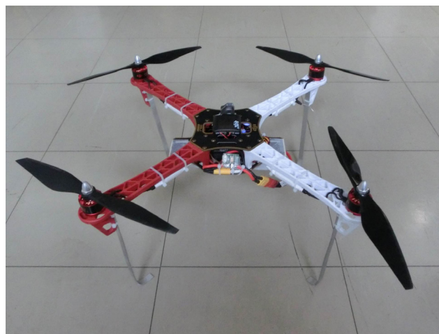
図 2 DJI 社製 クアッドコプター F450 Fig. 2 DJI F450 quadcopter.
