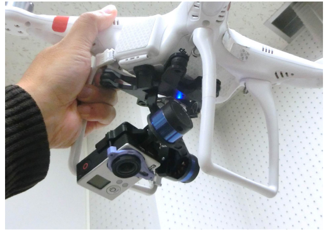
図 10 GoPro Hero3 用 2 軸 ブラシレス ジンバル Tarot T-2D. 機体の姿勢によらず常に真下を向くように設定してある。
