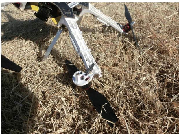
図 45 DJI F550 の墜落による腕の先端の損傷 Fig. 45 Damage on DJI F550's arm end by a crash.
