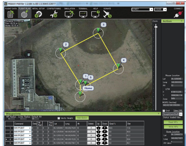
図 37 MissionPlanner の FLIGHT PLAN 画面。四角形のテスト用ミッション
