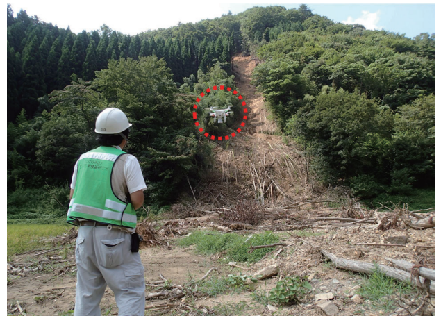
図 56 山口・島根豪雨災害空撮調査. 名賀川における表層崩壊の撮影(図 55 の A 点) Fig. 56 Aerial photo survey of Yamaguchi-Shimane flood/landslide disasters along Nayoshi river (at point A in Fig. 55).
