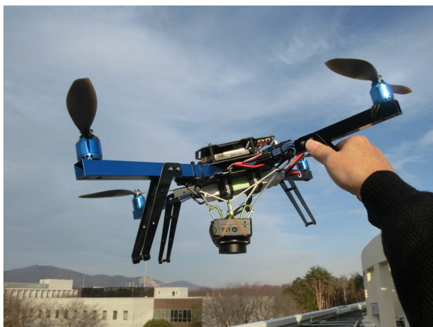
図 12 リコー GR 用ピカベイ Fig. 12 Picavet for Ricoh GR camera.
