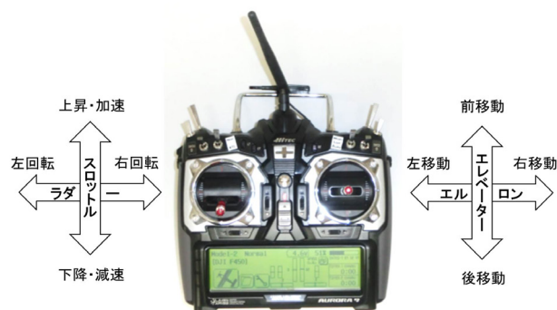
図 5 送信機(プロポ)のスティック操作(モード 2) Fig. 5 Manipulation of transmitter sticks (Mode 2).
