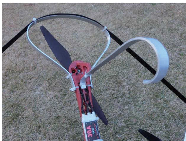
図 47 アルミフラットバー(幅 10 mm × 厚さ 2)で製作した DJI F450 のプロペラガード(130 g)とスキッド(52 g) Fig. 47 Propeller guards (130 g) and skids (52 g) for DJI F450 made by aluminum flat bar (10 mm width × 2 mm thick).
