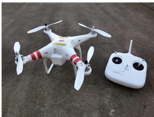
図 1 DJI 社製クアッドコプター Phantom と専用送信機（プロポ）（右）
