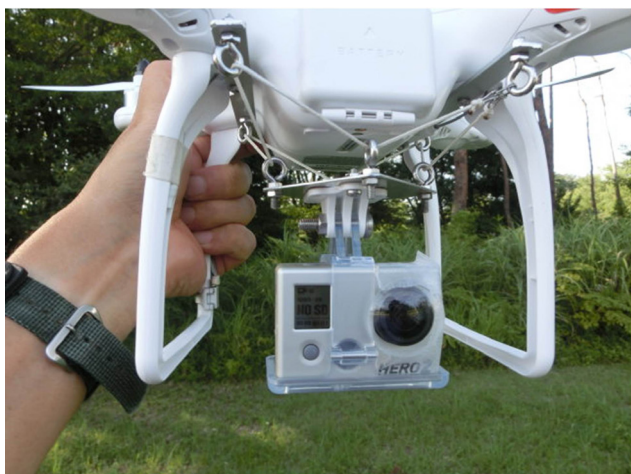
図 11 GoPro カメラ用ピカベイ Fig. 11 Picavet for GoPro camera.
