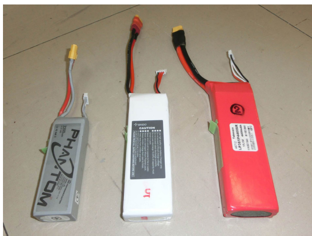
図 13 リポバッテリー。いずれも 3 セル 11.1 V、左から 2,200 mAh (175 g)、3,300 mAh (275 g)、4,400 mAh (360 g)
