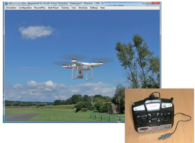
図 28 シミュレータ (Heli-X) の画面(上)と USB コントローラー(下右)
