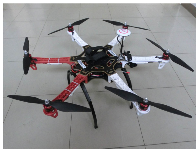
図 4 DJI 製 F550 ヘキサコプター Fig. 4 DJI F550 hexacopter.
