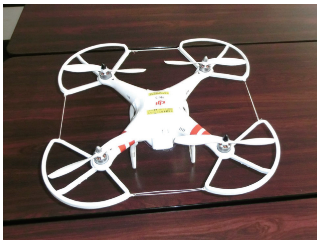
図 46 DJI Phantom のプロペラガード Fig. 46 Propeller guard of DJI Phantom.
