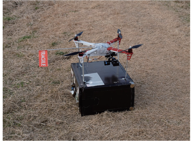
図 70 宝篋山麓の空撮実験に用いたマルチコプター DJI F450 と GoPro Hero3 および TarotT-2D ジンバル Fig. 70 Multicopter DJI F450 with GoPro Hero3 attached by Tarot T-2D gimbal.
