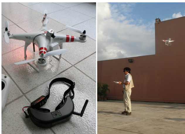
図 19 FPV システム (FatSharkTeleporterV3) とデモフライトの様子
