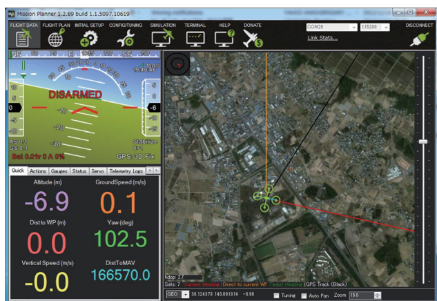
図 35 MissionPlanner の FLIGHT DATA 画面 Fig. 35 FLIGHT DATA screen of Mission Planner.
