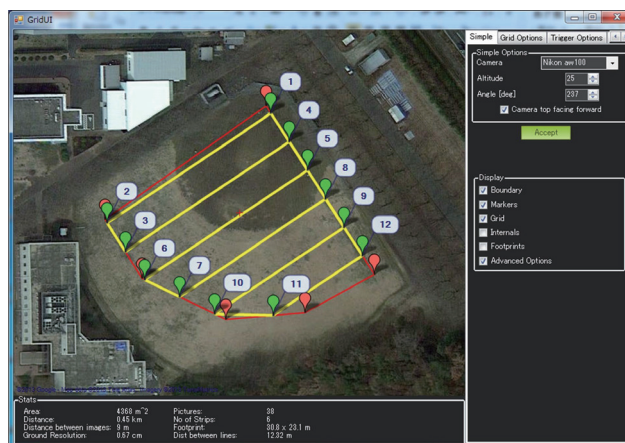
図 38 写真調査用自動 Waypoint 生成機能 Fig. 38 Auto Waypoint generation for photo survey.
