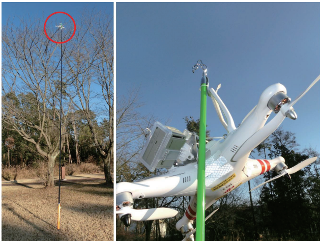
図 22 樹上不時着機体回収用の長さ 10 m の伸縮ポール Fig. 22 10 m long extension rod for retrieving multicopter landed on a tree.
