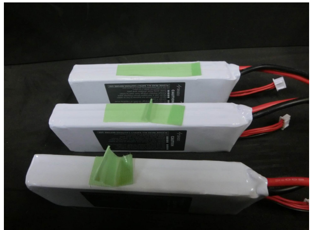
図 16 テープによるリポバッテリーの充電状態の区別, 上: 満充電, 中: 半充電(保管電圧), 下: 使用済み
