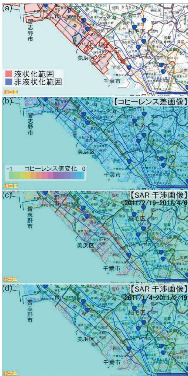
図-10 習志野市～千葉市の湾岸沿いの液状化発生領域 (a), コヒーレンス差画像 (b), SAR 干渉画像 (c) (d). コヒーレンス差画像は図-7 (b) と同じ. SAR 干渉画像はそれぞれ 2011/2/19-2011/4/6 及び 2011/1/4-2011/2/19 のデータペアによる解析結果.
