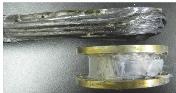
図 11 破断した肩部とシンプルの表面
