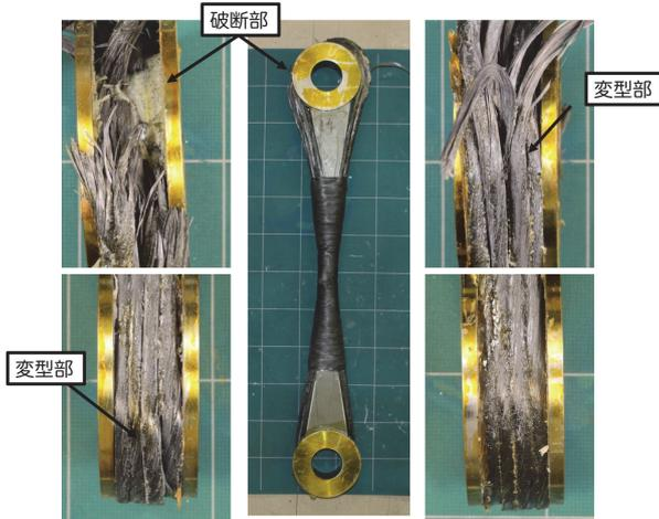
図 10 CF ペンダントの破断後の様子
