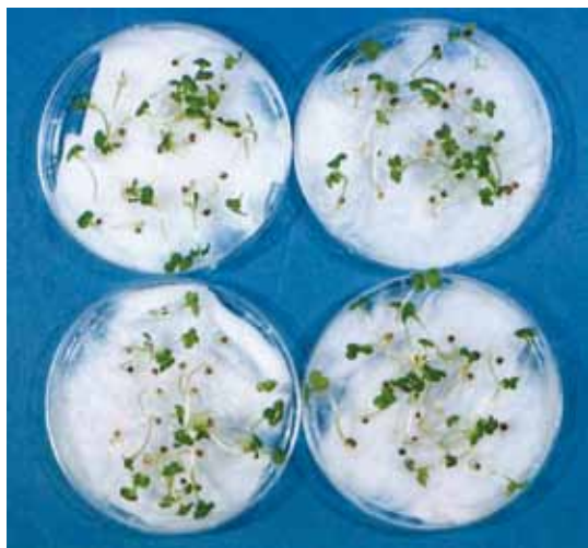
図—10 中和液による小松菜の発芽試験( \text{Ca}(\text{OH})_2 1.5g/l を \text{H}_2\text{SO}_4 で pH7.2 まで中和した)
