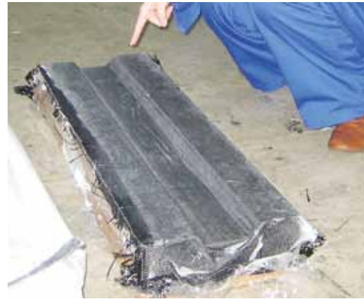
(b) 木型の形状に硬化した桁
