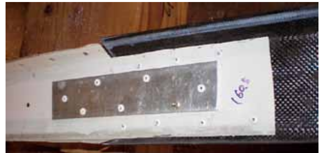
(d) 完成したエルロン桁
