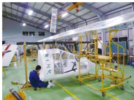
図 4.9 フェアリング完成図(右翼から)
