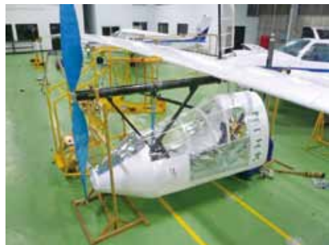
図 4.8 フェアリング完成図(左翼から)
