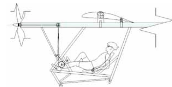
図 3.1 胴体フレーム側面図
