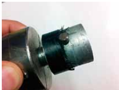
図 1：ドライブシャフトピン孔の面圧破損
