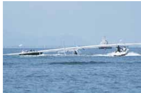
図 5.2 着水後も沈まない機体
