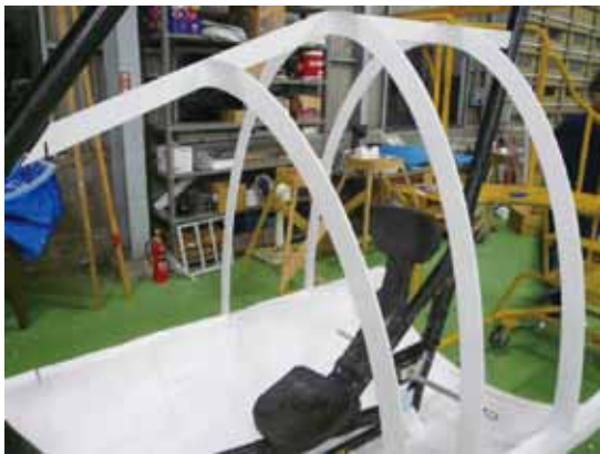
図 4.3 パイロット格納部の骨組
