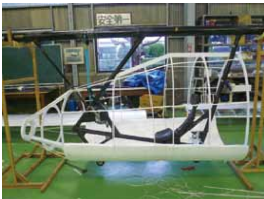
図 4.4 フェアリングの骨格完成後
