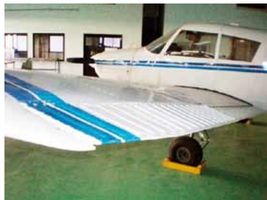
(d) 取り付けられたエルロン組立
