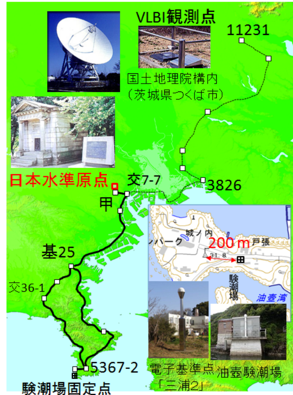
図-16 日本水準原点の原点数値計算に使用する水準路線図
