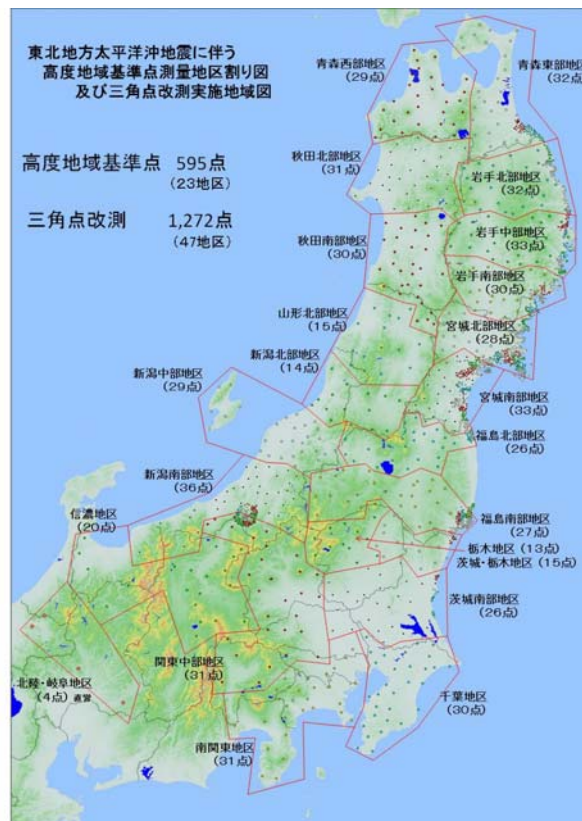
図-18 東北地方太平洋沖地震に伴う高度地域基準点測量及び三角点改測実施地域図
