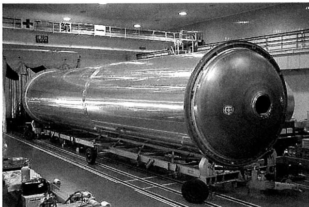
図2 ロケット推進薬タンク外観 ロケットタンクの代表例として、現行のH-IIAロケット1段液体水素タンクの外観を示す。
