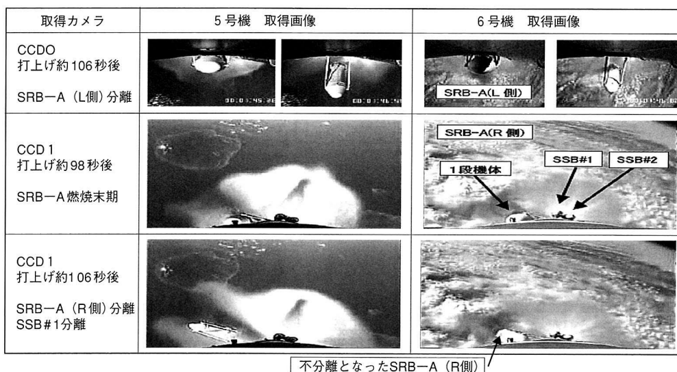
図2 H-IIAロケット機体搭載 CCDカメラの取得画像 6号機でのSRB-A不分離の状況を、正常分離した5号機との比較で示す。
