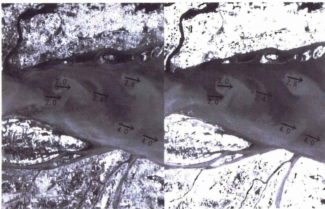
図2 左右に並べた時間差画像。水塊の位置の動きを測定して速度ベクトルを計測する。実体視すると矢印が水面上の空間に浮かんでいるように見える（カメロン効果）
