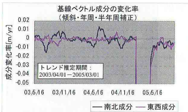
図-5 筑紫野-福岡基線ベクトル成分の変化率 90日間のデータを1日ずつずらして計算。表示位置は、計算期間の中間日。最終表示日は2005年9月29日
