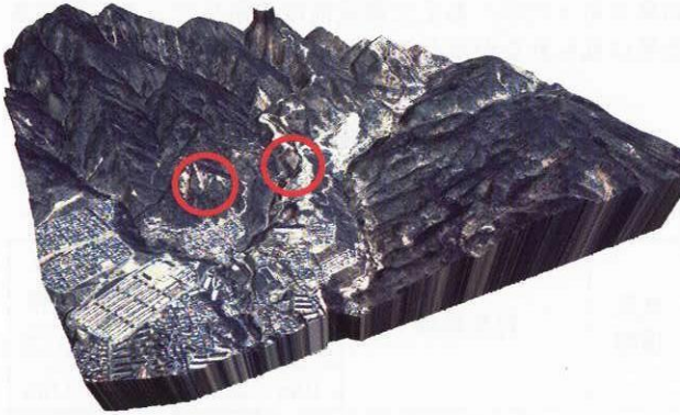
図-2 DEMを活用した山腹崩壊の判読例
