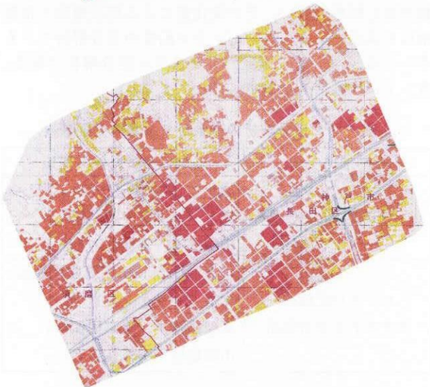
図-4 レベルスライスによる延焼域自動抽出 (上段はALOS PRISM画像のレベルスライス, 下段は災害現況図(赤色部分が液状化域))
