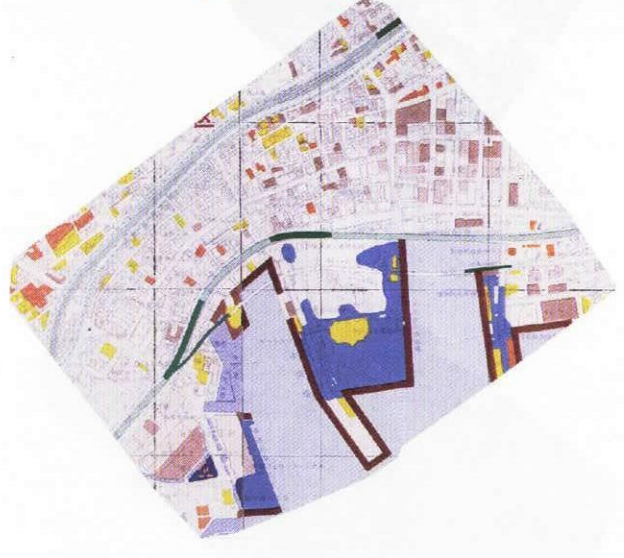
図-5 クラスター分類による沈下域自動抽出 (上段は地理情報マスク後のALOSパンシャープン画像をクラスター分類したもの, 下段は災害現況図(茶色部分が沈下域))
