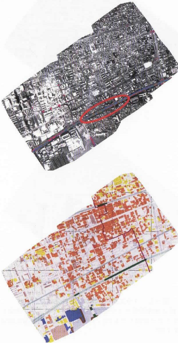
図-6 テクスチャ解析による高架橋落下域自動抽出 (上段は地理情報マスク後のALOS PRISM画像をテクスチャ解析したもの、下段は災害現況図(緑色部分が高架橋落下域))
