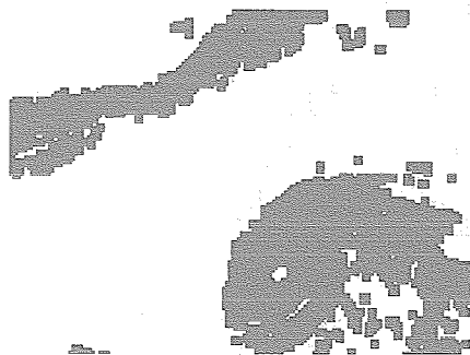
図5-3 2値画像に8近傍収縮膨張した結果
