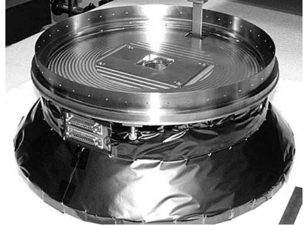
図3. XRT-S概観 カメラ上部の腕は焦点調節ロッド
