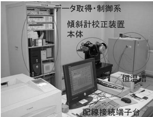
図 1 JAXA 風洞技術開発センター傾斜計校正装置概観
