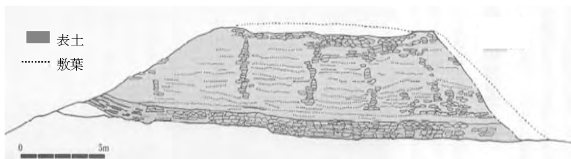
図-7 狭山池築造当初の堤断面(「東アジアの敷葉工法」より)
