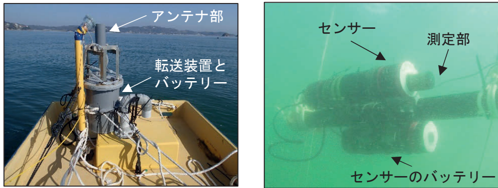
図 2. 本研究で設置した硝酸塩センサー（ISUS V3）と転送装置
