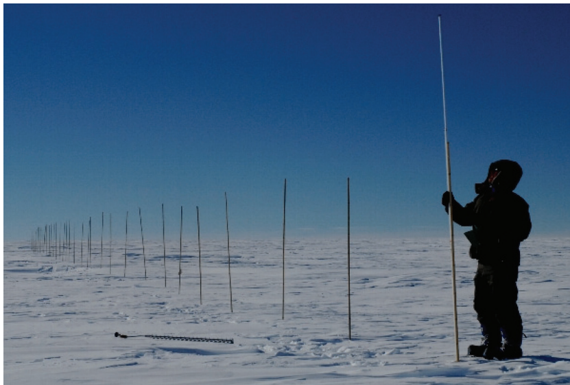
図 19 日本-スウェーデン会合点での雪尺網の設置と計測作業風景
