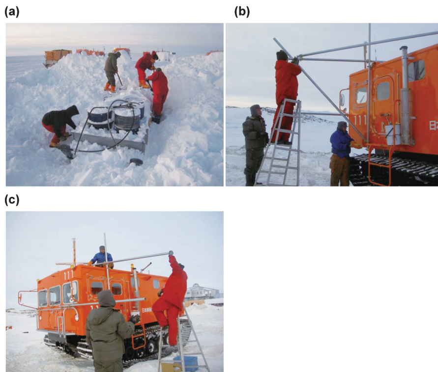
図3 第48次日本南極地域観測隊による、2007年10月までのトラバース準備の事例写真。(a) S16地点での埋没橇の掘り出し。(b)、(c) 短管パイプを用いて、レーダアンテナ取り付け機構を雪上車に設置。
