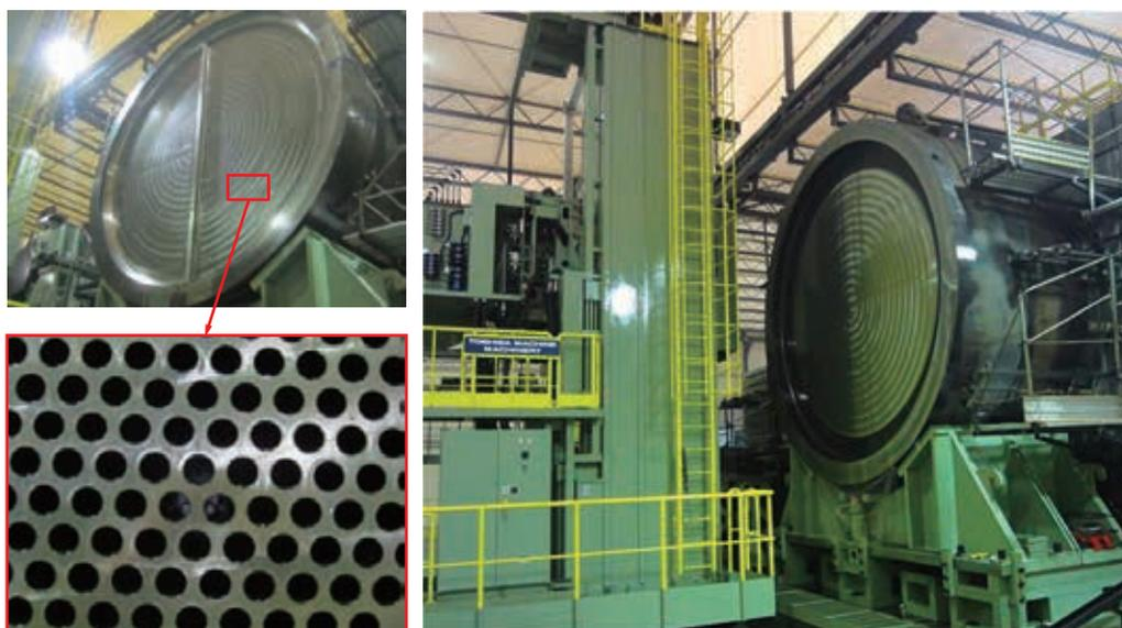
管板 BTA ( Boring and Trepanning Association ) 深孔加工機
