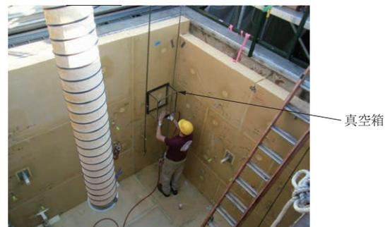
第7図 セカンダリバリアの真空試験状況
