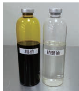
MOBURA（油サンプル） 左：抽出直後、右：精製後
