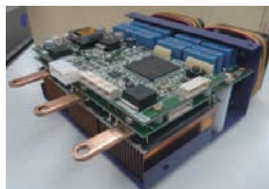
小型軽量インバーター（出力 35 kW, サイズ約 500 cc, 質量約 660 g）
