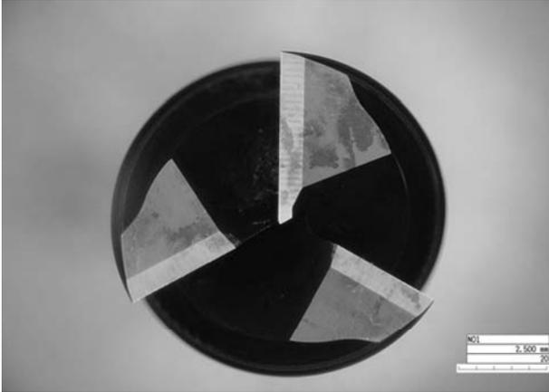
図10：一定体積ドライ除去加工用の工具形状。
