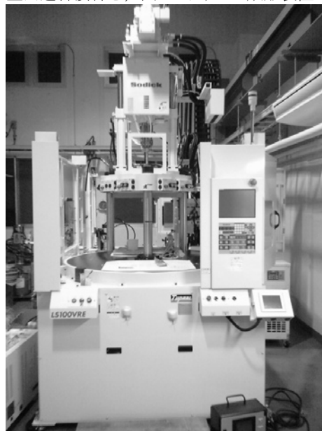
図3：型内適合接合プロセスのためのLIM成形機。
