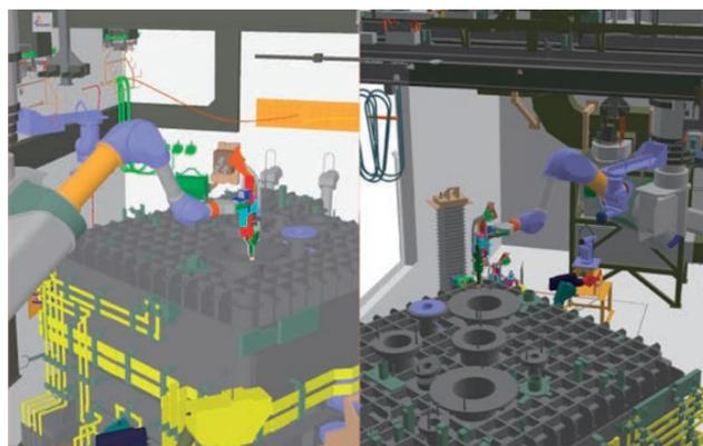
3D-CAD を用いた遠隔操作シミュレーション
