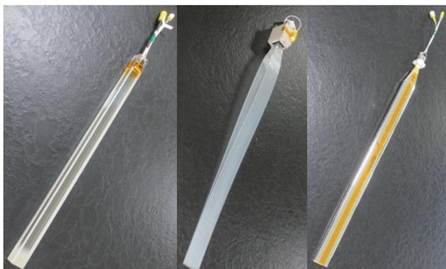
左：全吸収型カロリメーターセンサー（タングステン酸鉛結晶シンチレーター）
