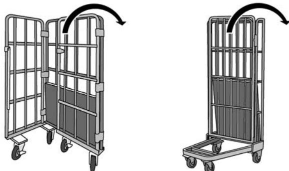
図 6-8 折りたたんだ状態で転倒しやすい方向
