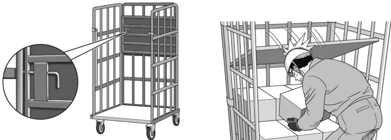
図 5-3 据付型中間棚および棚の落下による頭部受傷イメージ
