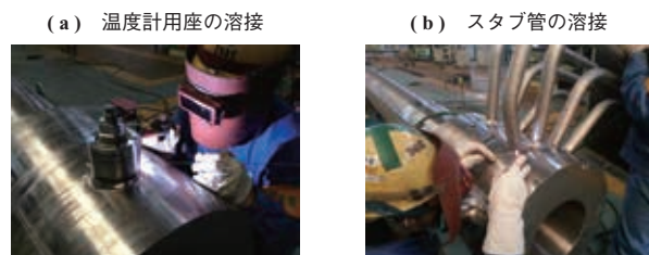
第14図 モックアップ製作時の様子 Fig. 14 Preparing for the mock up trial
