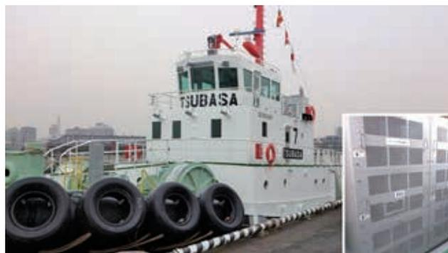
IHI 製リチウムイオン電池システムを搭載したハイブリッドタグボート「翼」
