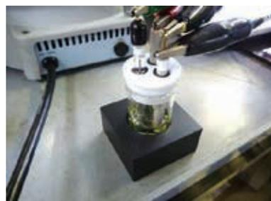
アミン修飾電極を用いた実験の様子
