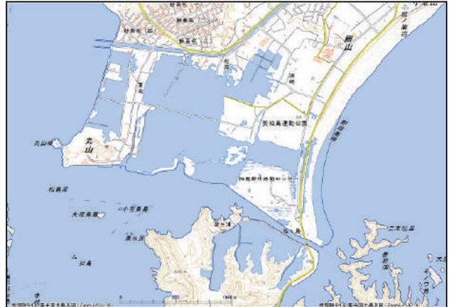
図-7 宮城県東松島市の海岸付近の電子国土基本図と東北地方太平洋沖地震の地殻変動による位置のずれを補正した地震前の海岸線データ(青線)の重畳
