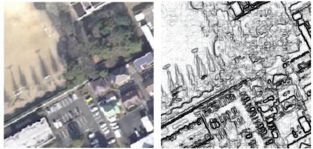
図-9 元の画像 (左) と Sobel フィルタをかけたエッジ画像 (右)
