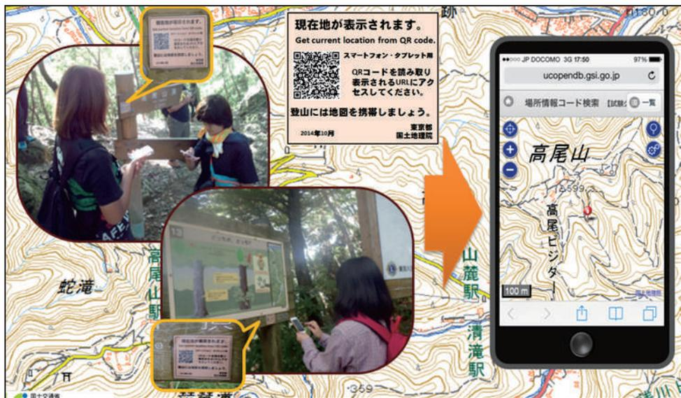
図-7 登山者がスマートフォンの衛星測位機能を使わなくても自分の位置が地形図上で確認できる
