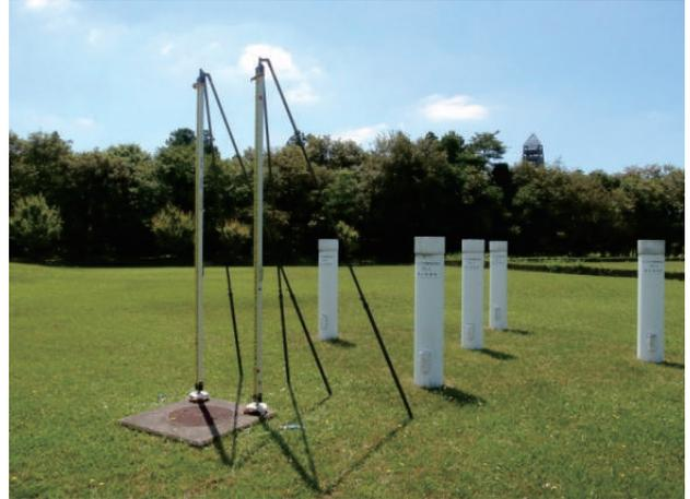
写真-3 水準測量用標尺の設置状況
