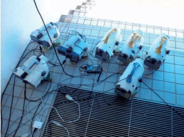
写真-2 電子レベルの設置状況
