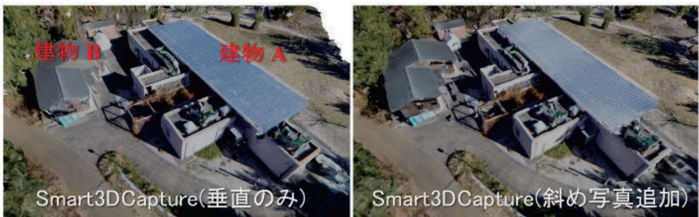
図-18 斜め写真による再現性の比較
