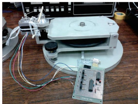
写真4 電子レベル自動傾動装置
