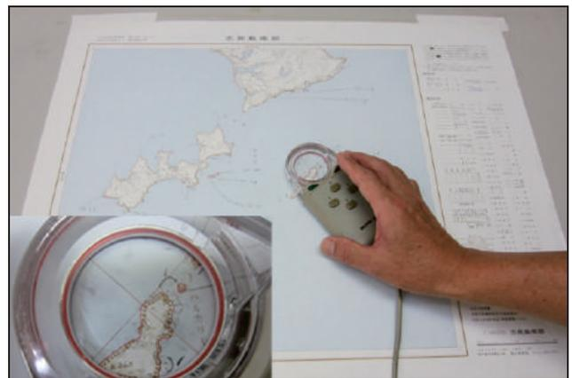
写真-1 紙の地形図上で座標計測機を用い、海岸線や行政界を手作業でなぞり座標を取得
