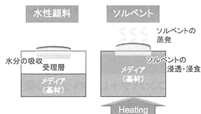
図1 水性顔料とソルベントの定着プロセスの違い
