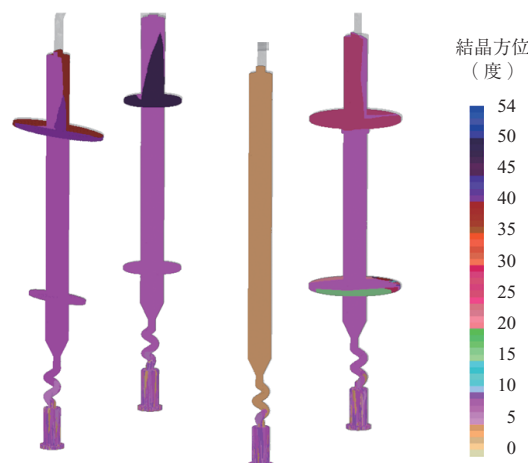
第 5 図 単結晶鑄造における等軸晶の発生予測例 Fig. 5 Prediction example of equiaxed grain in single crystal casting
