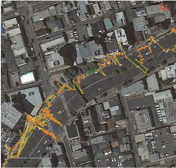
図-15 3次元建物法を適用した多地点観測結果の一部 ●:Fix 解 ●:Float 解 (電子基準点「神戸中央」との2周波 RTK)
