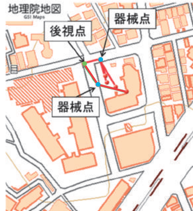
図-8 定点観測における地上測量の配置
