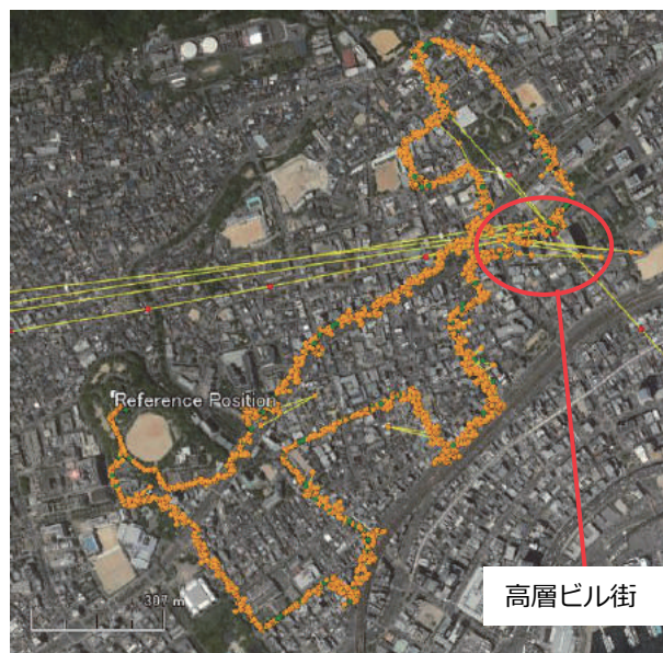
図-14 3次元建物法を適用した多地点観測結果の全体図 ●:Fix 解 ●:Float 解 ●:Single 解 （電子基準点「神戸中央」との2周波RTK）
