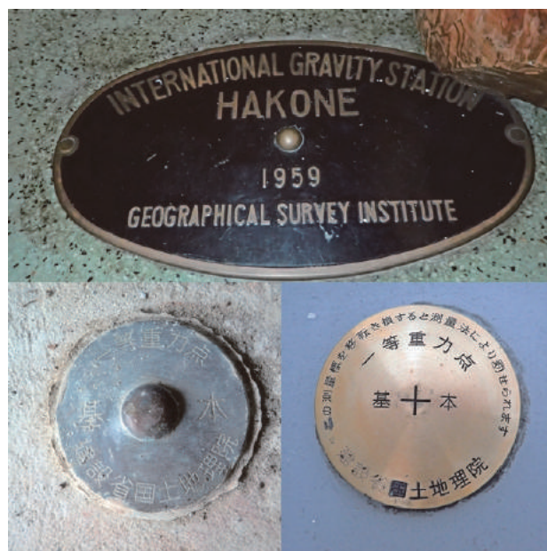
写真-6 一等重力点の形状。写真上：箱根GS。1959年設置。写真左下：松代GS。1984年設置。写真右下：名古屋GS。2013年設置。いずれも2015年撮影。
