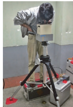
写真-2 ラコスト重力計による重力鉛直勾配の測定風景 (2003 年京都 C)。重力点直上 1.20m で観測。
