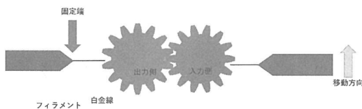
図24. モーメントバランス法のマイクロギアへの適用モデル
