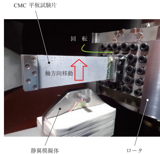
第 27 図 回転衝撃試験の試験形態
