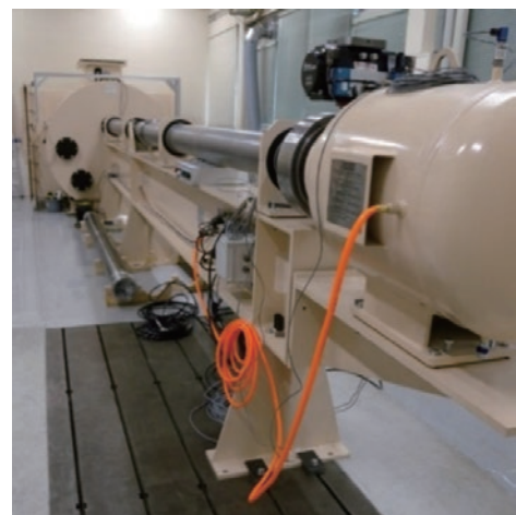
第6図 静止衝撃試験装置（JAXA 所有） Fig.6 Static impact test facility at JAXA
