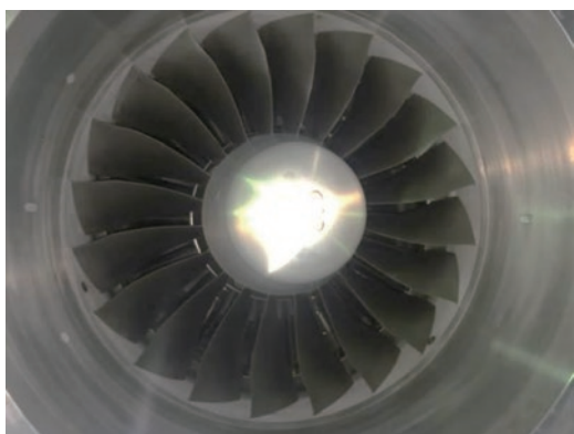
第 12 図 ファンスケールリグ Fig. 12 Scaled fan rig
