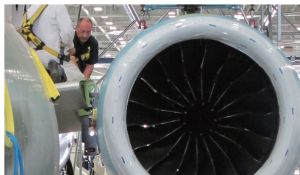
第 6 図 機体に搭載された GE Passport 20 エンジン
