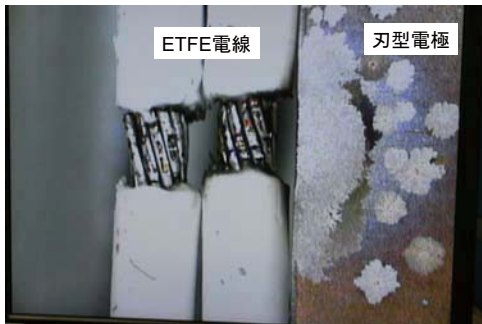
図 13 実験後の刃型電極試料の状況
