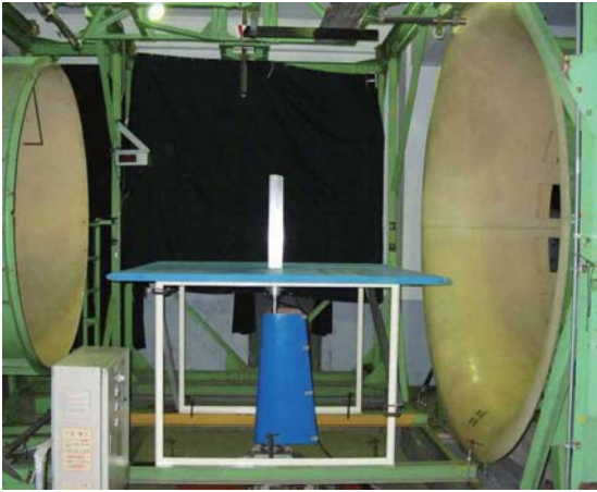
図3 ブレード単体風洞試験
