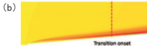
図11 運動量厚さレイノルズ数分布 (a) Sharp Nose (b) Blunt Nose
